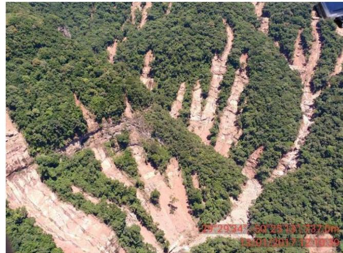
**Enxurrada** no município de Rolante em janeiro de 2017. Cerca de 350 **deslizamentos** represaram as águas do Rio Mascarada, que, ao se romper, causaram a enxurrada.
